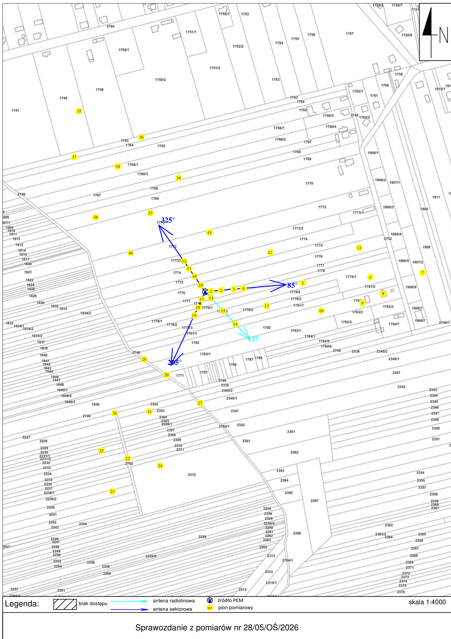
Rys. 2 Lokalizacja pionów pomiarowych
