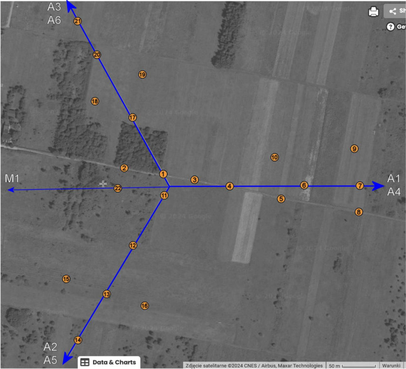
Załącznik nr 2: Lokalizacja anten oraz ich azymuty, lokalizacja pionów (punktów) pomiarowych wokół instalacji radiokomunikacyjnej. Mapa źródłowa: Geoportal. -punkt (pion) ● pomiarowy.
