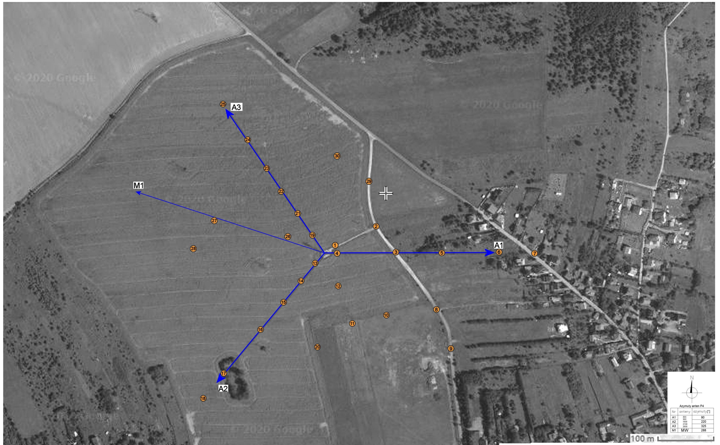
ZaŃ. nr 2: Lokalizacja anten oraz ich azymuty, lokalizacja pionów (punktów pomiarowych wokół instalacji radiokomunikacyjnej). -punkt (pion) pomiarowy.
