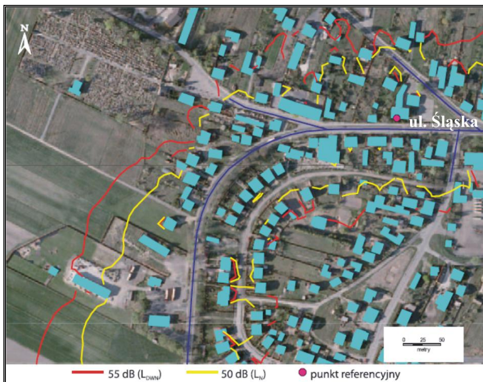
Rysunek 9. Fragment mapy akustycznej dla wskaźnika oceny hałasu LDWN i LN w rejonie badań RB2 - ul. Śląska, Szczekociny, 2009 r. (Źródło: WIOŚ Katowice)
