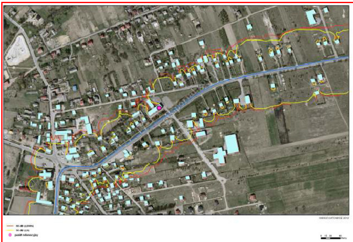
Rysunek 3. Fragment mapy akustycznej dla wskaźnika oceny hałasu LDWN i LN w rejonie badań RB1 - ul. Kościuszki, Kroczyce, 2011r.
