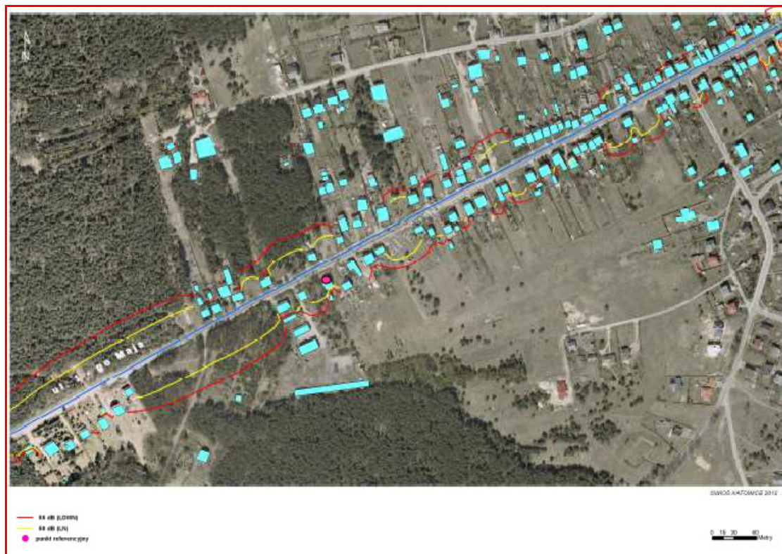
Rysunek 5. Fragment mapy akustycznej dla wskaźnika oceny hałasu LDWN i LN w rejonie badań RB1 - ul. 1-Maja, Ogrodzieniec, 2011r.
