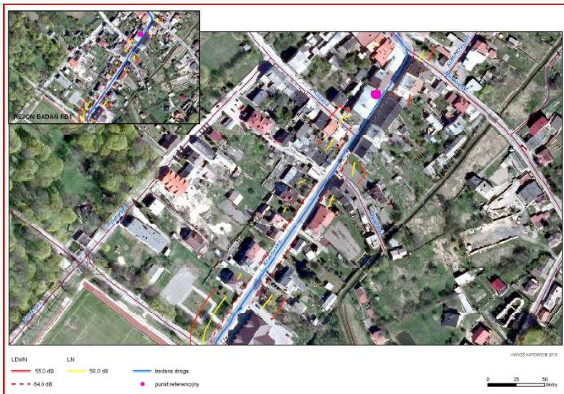
Rysunek 7. Fragment mapy akustycznej dla wskaźnika oceny hałasu LDWN i LN w rejonie badań RB1 - ul. Krakowska, Pilica, 2012r.
